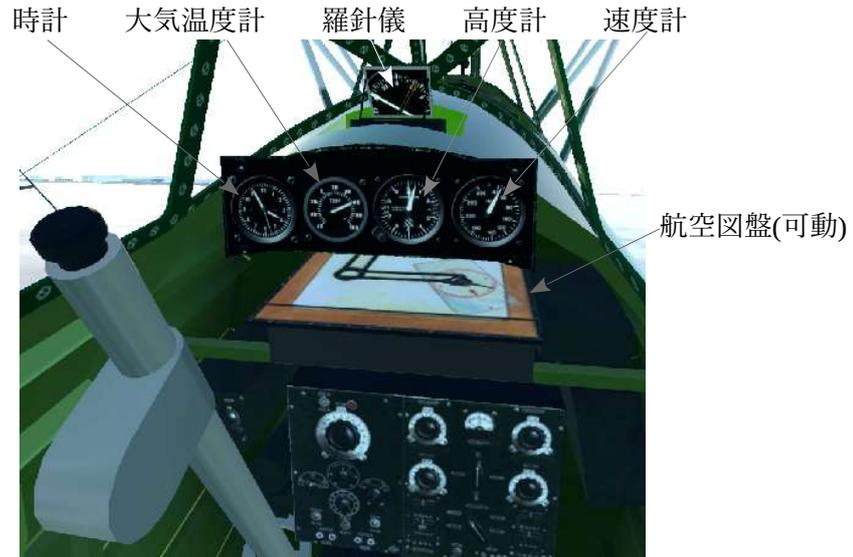
**離水方法：**フラップを一段下げスロットルを最大にして水上滑走し、速度 65 kt 付近で離水します。
